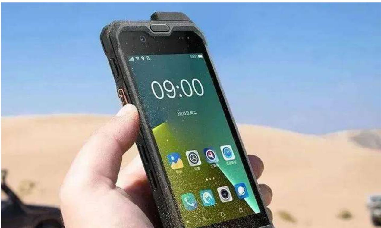
**Hytera PNC460U** è un dispositivo intelligente certificato UL913 con le funzionalità di uno smartphone a grande schermo e di una radio push-to-talk over cellular (PoC) riunite in uno solo dispositivo.
